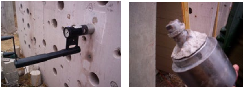
Figura 2: Equipo Capotest Instalado y Inserto Cónico extraído
