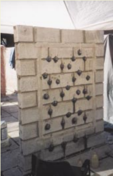
Fotografía 2.- Distribución de pipetas en un muro
