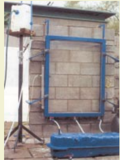
Fotografía 1. - Ensayo ASTM E 514-90
