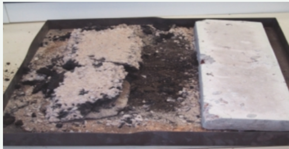
Muestras de asfalto (izq.) y hormigón (der.) después de calentarse a 750°C.
